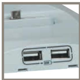
Der Tower besitzt 2 USB-Steckplätze sowie einen Mini-USB-Steckplatz zum Anschluss von diversen Geräten.
