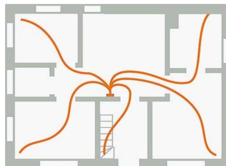
Der Saugschlauch von 8 m bietet mit einer zentralen Saugdose einen großen Wirkungsradius
